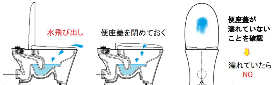
図 2-3-8 トイレ封水の跳ね出し監視方法
