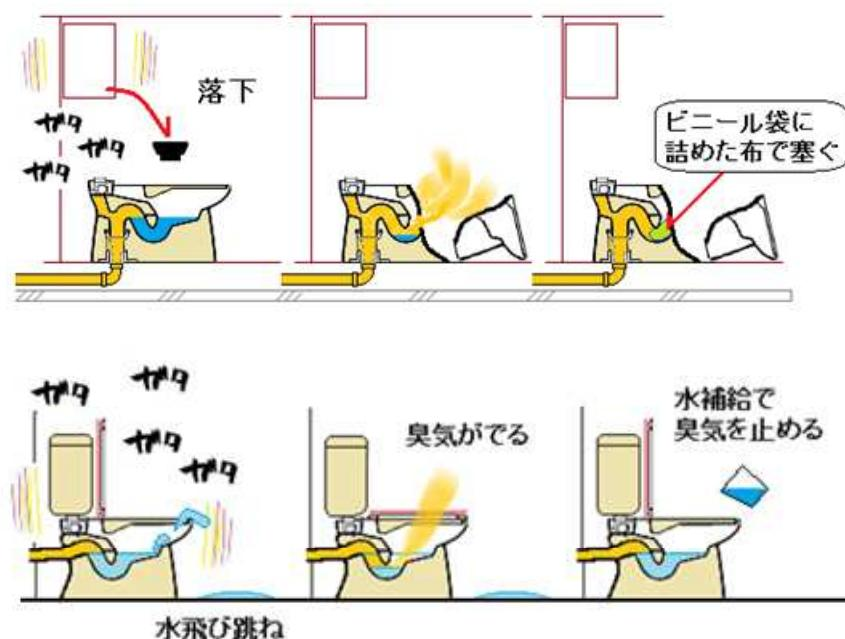
図 2-3-4 破損した便器の対応・封水の補給（入居者）
